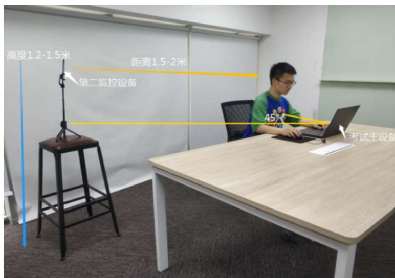
图：第二视角云监考（鹰眼）监控设备摄像头须架设在考试设备的侧后方
